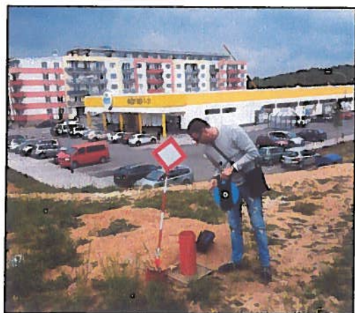
Obr. 8.1 měření hladiny podzemní vody ve vystrojeném vrtu HV13
